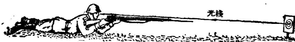
图3 在瞄准时利用光綫的直綫性，經槍靶、准星和照門通过一条直綫——光綫
